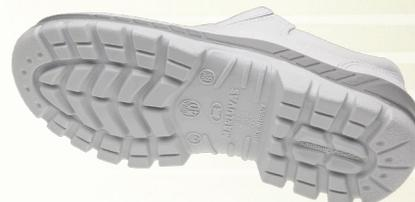
**Solado** Constituído de duas camadas de poliuretano (PU), injetado diretamente no cabedal, sendo a 1ª camada (entressola) mais macia e leve, com densidade de 0,4g/cm<sup>3</sup> proporcionando maior conforto; e 2ª camada (sola) mais compacta com densidade de 0,9 g/cm<sup>3</sup>, resistente a objetos cortantes, perfurantes e a abrasão com sistema antiderrapante constituído de ranhuras especiais de 3mm de altura e 6mm de largura.
