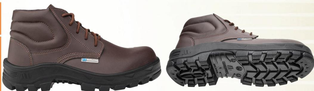
**Solado** Constituído de duas camadas de poliuretano (PU), injetado diretamente no cabedal, sendo a 1ª camada (entressola) mais macia e leve, com densidade de 0,4g/cm<sup>3</sup> proporcionando maior conforto; e 2ª camada (sola) mais compacta com densidade de 1,0 g/cm<sup>3</sup>, resistente a abrasão com sistema antiderrapante constituído de ranhuras especiais de 3mm de altura e 6mm de largura e resistência ao escorregamento em piso cerâmico e piso de aço (Nível SRC).
